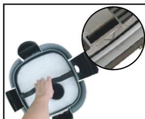
Vuelva a colocar las canastillas del filtro y asegúrese de que la flecha que hay en la canastilla está alineada con la del vaso.
