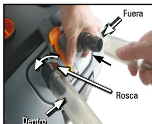
Conecte la manguera de entrada a la válvula marcada con "in" y la manguera de salida a la válvula marcada con "out". Asegure las mangueras con la rosca.
