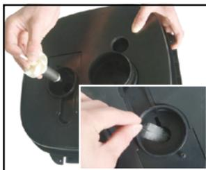
Extraiga el impulsor para limpiarlo o cambiarlo, según corresponda. Limpie el interior del acuario con una escobilla.
