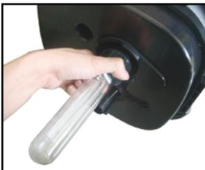
Afloje la rosca de cuarzo UV; extraiga la cubierta de cuarzo UV, la tuerca y el anillo obturador.
