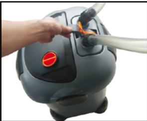
Ponga la palanca de la base de la válvula en posición de "cerrado" y extraiga la base de la válvula.
