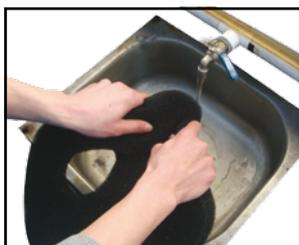
Lave el medio de filtrado sólo con agua y póngalo en las canastillas del filtro según sea preciso.
