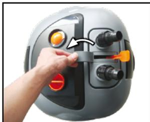
Cuando la base de la válvula esté en posición, vuelva a llevar la palanca a la posición de "cerrado".
