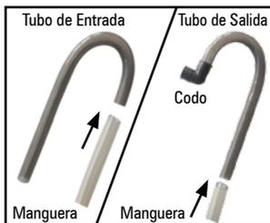
Inserte la manguera, al menos 3cm, a los tubos de entrada y salida.
