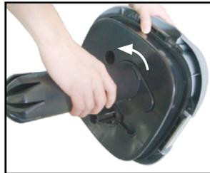
Extraiga el cabezal de la bomba como se indica en los pasos 1 a 2, desenrosque y extraiga la cubierta de la lámpara UV.
