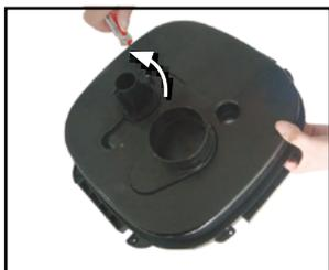
Saque el cabezal de la bomba, desenrosque la cubierta del impulsor con una llave.
