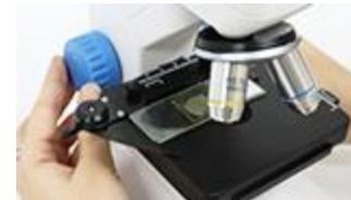
Tras seleccionar el objetivo adecuado, rote lentamente la rueda de enfoque macro hasta que la imagen se muestre enfocada y nítida en la pantalla LCD.
